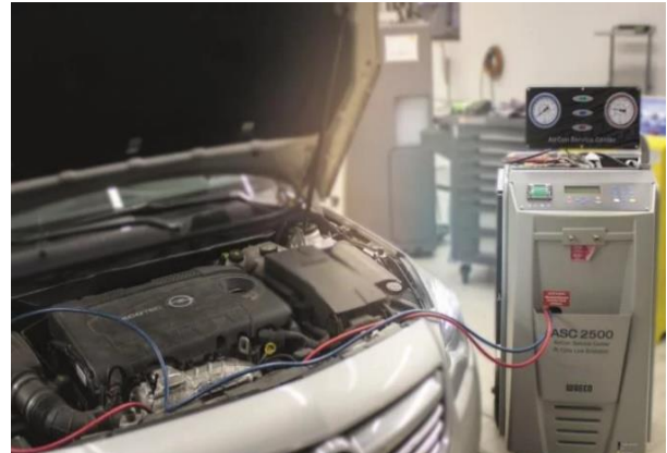
Kältemittelbefüllung. Quelle: ADAC Klimaservice
