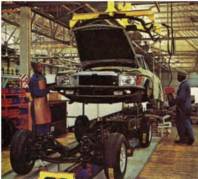
7. Vereinigung der ausgestatteten 450SLC Karosserie mit dem Fahrgestell
