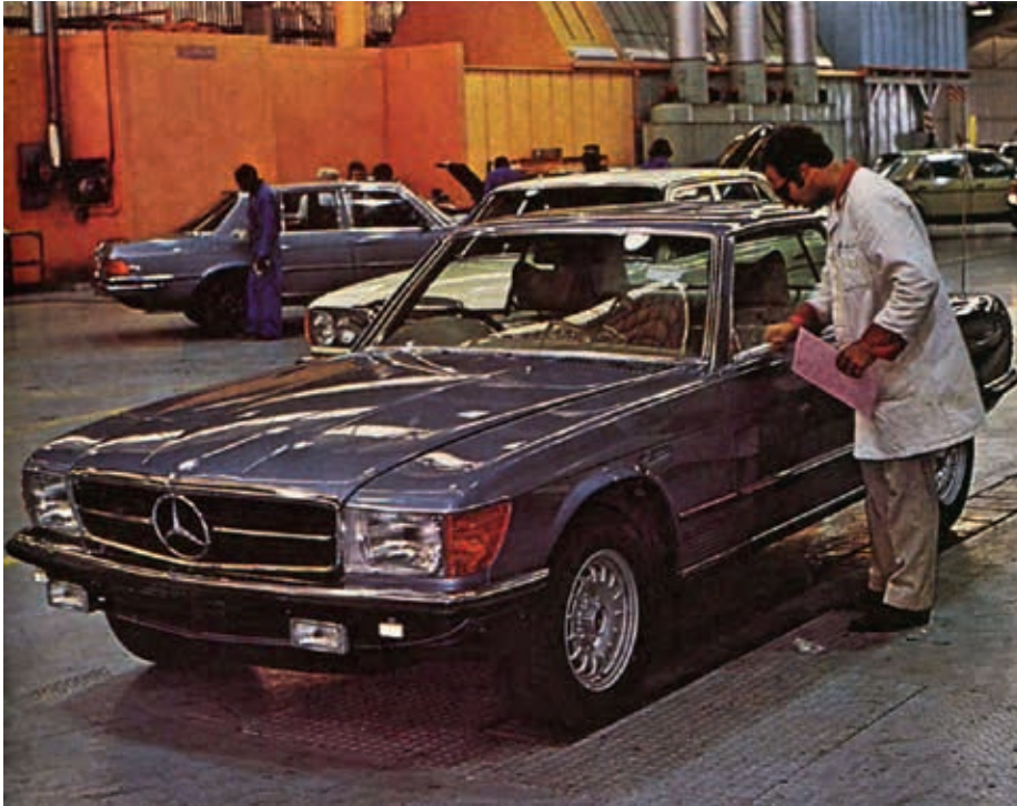
10. 450 SLC Endkontrolle in der Fehlerbehebungshalle
