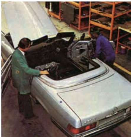
5. Einbau der Sitze in einem 450SL. Für Fotos 3-5 wurden die schützenden Abdeckungen entfernt
