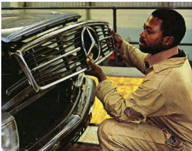
9. Der Kühlergrill wird als eines der letzten Teile montiert
